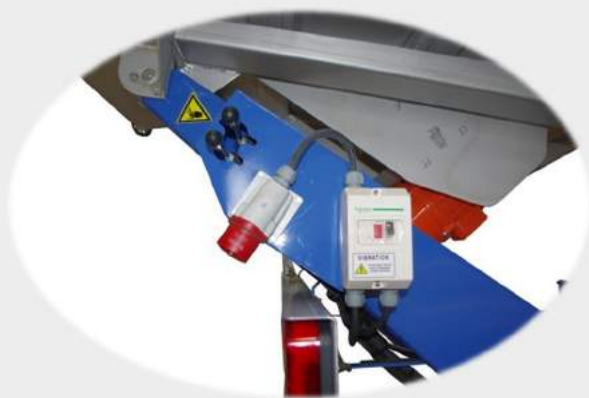
La opción "Doble Control" : Inclinación y Elevación están controladas desde el remolque
