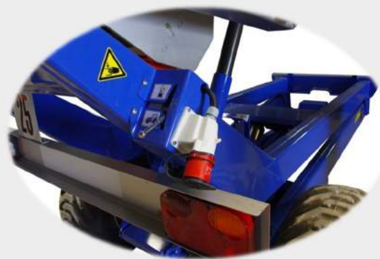
La opción "Circuito Doble" permite inclinar desde la central o tractor. (La elevación se queda con el tractor)
